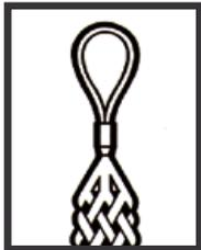
Freileitungsziehstrümpfe werden zum effizienten Ziehen von Kupfer-, Alu- und Stahlaluseilen im Freileitungsziehbau eingesetzt. Die besondere Flechtart mit dreilagigem Geflecht und dem optimierten Maschenabstand garantieren höchstmögliche Sicherheit und Kraftschluss auf dem zu ziehenden Material. Die flexible, aufgespreste Öse sorgt für einen problemlosen ROLLDURCHLAUF des Strumpfes. Selbstverständlich sind diese Strümpfe auch in Kran-, Bagger- und Aufzugsanlagen einsetzbar.
