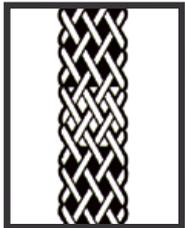
Mit zwei unterschiedlichen Durchmessern, speziell zum Auswechseln von Kranseilen-, Hilfs- und Hauptseilen in einem Zugvorgang (z. B. Seil- $\emptyset$  10/28 mm o. ä.). Das drei- auf zweilagige Geflecht ist aus verzinkter Stahllitze, beidseitig offen, ohne Ösen.
