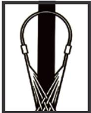
Die leichtere Flechtart dieser Strümpfe bedeutet ein optimiertes Handling bei minimalem Gewicht. Trotzdem sind sie das sicherste und effizienteste Befestigungsmittel für freihängende Kabel oder Seile. Ob in Schaltschränken, Antennenanlagen,
