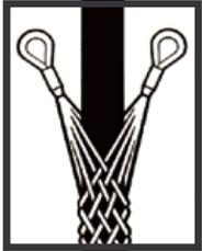
Kabelnachziehstrümpfe mit zwei aufgedrehten Kauschen oder Ösen gibt es in beidseitig offener und in seitlich ganz offener Flechtart. Man verwendet sie zum Ziehen, Nachziehen und Befördern schwerer Kabel oder Rohre jeder Art.
